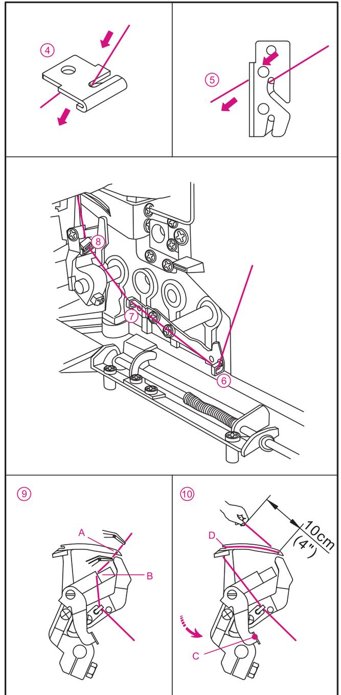
**(2) Enhebrar la Guja de la Derecha Para Puntada Recubridora (rojo) (E en el sujetador de aguja)**
