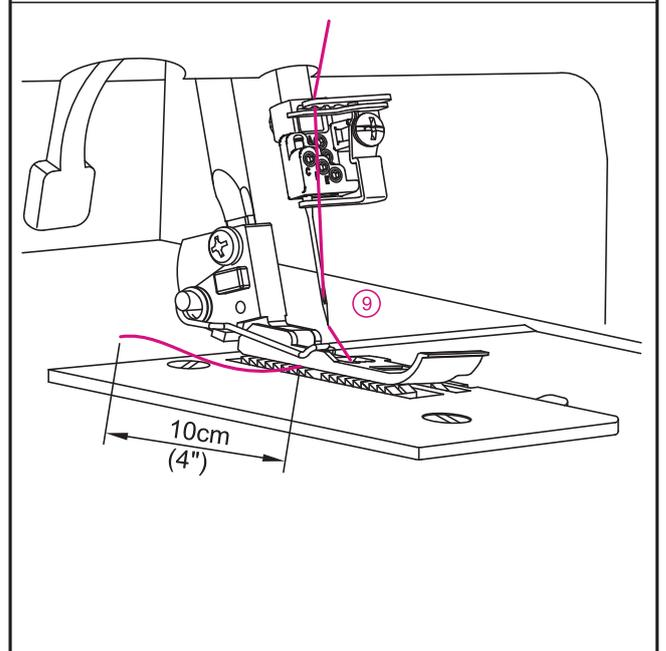
**Diagrama de enhebrado: Puntada de recubrimiento - Ancha y doble**
