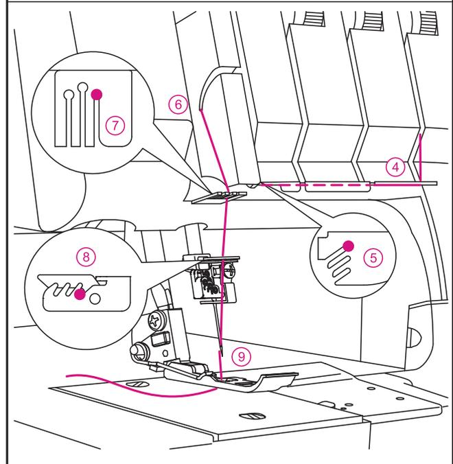
Antes de enhebrar la aguja, asegúrese que el hilo pasa **por delante del guiahilos** localizado debajo del sujetador de agujas para la puntada recubridora.
