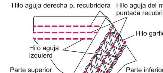
**Diagrama de enhebrado: Puntada de recubrimiento: estrecha y doble**
