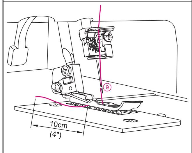
**(3) Enhebrar la Aguja del Medio Para Puntada Recubridora y Punto Cadeneta (verde) (D en el sujetador de aguja)**
