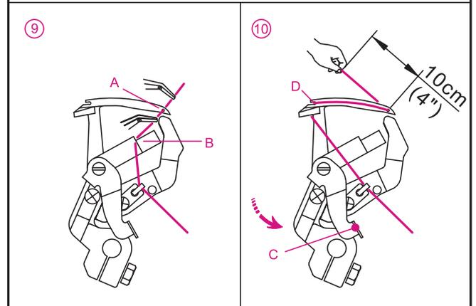
**(2) Enhebrar la aguja del medio para puntada recubridora y punto cadeneta (verde) (D en el sujetador de aguja)**
