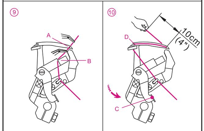
**(2) Enhebrar la Guja de la Derecha Para Puntada Recubridora (rojo) (E en el sujetador de aguja)**
