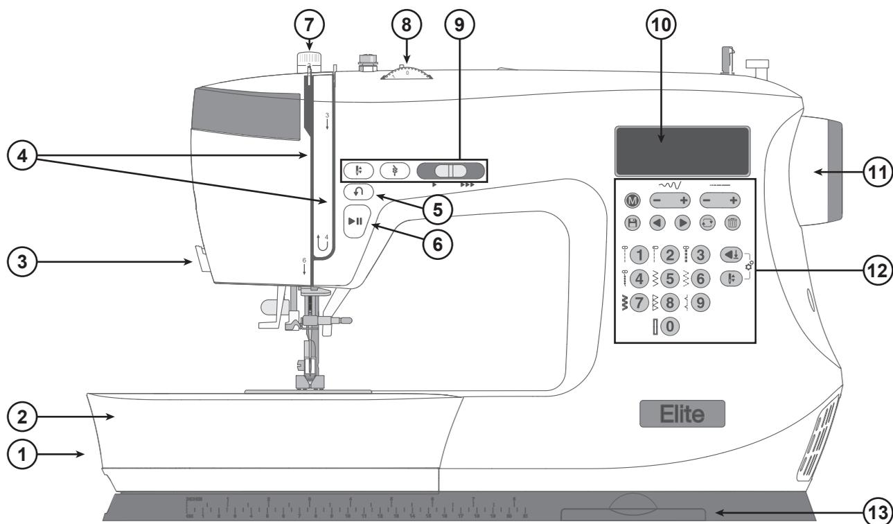
1. **Palanca de dientes de arrastre** - mover de lado a lado para enganchar o desenganchar los dientes de arrastre. Posicionado en la parte posterior del brazo libre.
