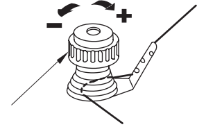
Ensartando la tensión previa para el devanado de bobina
