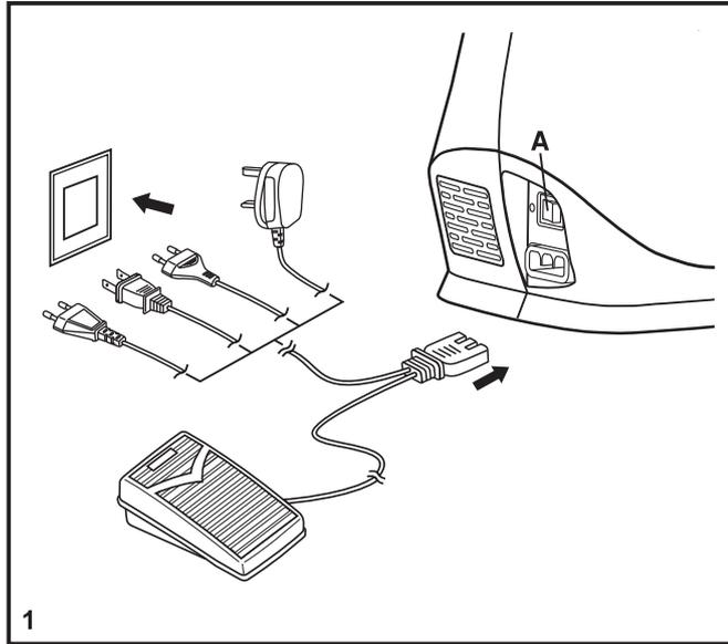
Conecte la máquina a una fuente de alimentación según se ilustra. (1)
